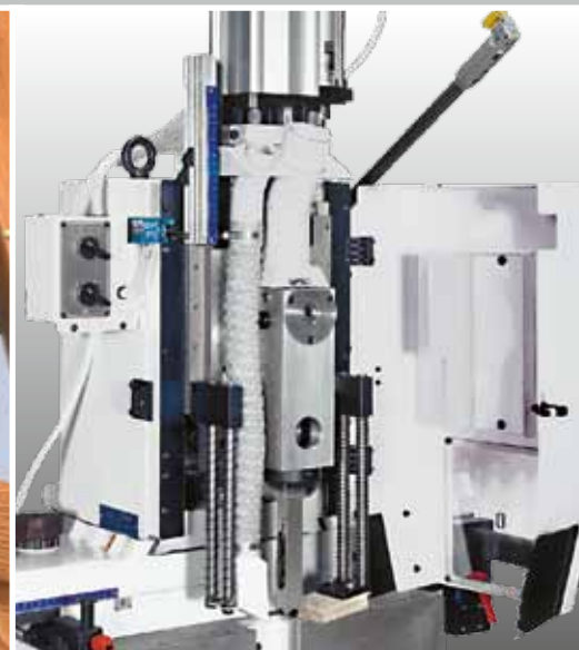
Particolare dell'unità porta-bedano. Detail de l'unité porte-bédane. View of chisel-holder unit. Detailansicht des Lochbeitelaggregates. Especifico de la unidad porta-herramienta bedano cuadrado
