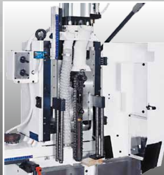
Particolare del gruppo porta catena. Detail de l'ensemble porte-chaîne. Front view of chain-holder unit. Detailansicht des Kettenaggregates. Especifico del grupo porta-cadena
