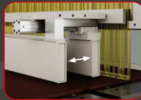
Pressore variabile per tagli 90° di qualità migliore Variable presser for better quality 90° cuts Presseur variable pour des coupes à 90° de meilleure qualité Presor variable para cortes de 90° para una mejor calidad
