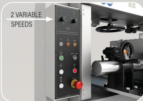
Pannello comandi con selezione velocità tramite potenziometri
