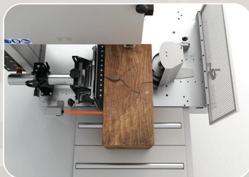
Sensore ottico per avvio ciclo di taglio e cambio velocità
