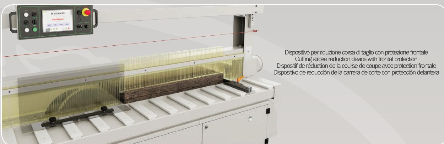
Dispositivo per riduzione corsa di taglio con protezione frontale
