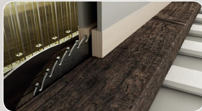
Sistema di bloccaggio pezzo con pressore pneumatico a barra
